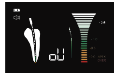
c) Die Datei hat den Apex bereits den Apex überschritten
