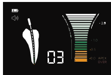
b. Die Feile befindet sich sehr nahe am Apex überschritten
